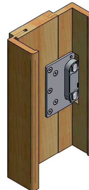
ocelový element k uchycení 3D pantu
